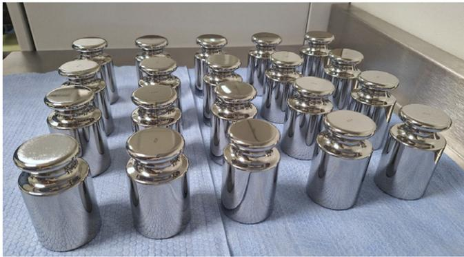
**FIGURA 1.** Pesas utilizadas como patrón con identificación CMP-M1-183/184/185/186.
