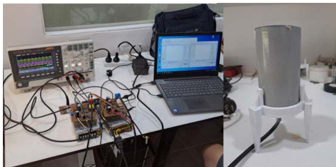
FIGURA 2. Dispositivo de ultrasonido utilizado, con su transductor (derecha) y amplificador conectado, con frecuencia y potencia medidas en osciloscopio y registradas en software (izquierda).
