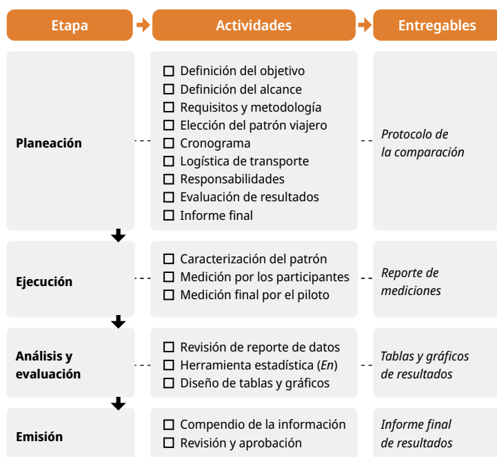
FIGURA 1. Esquema simplificado del proceso realizado en la comparación interlaboratorio en los dos países.
