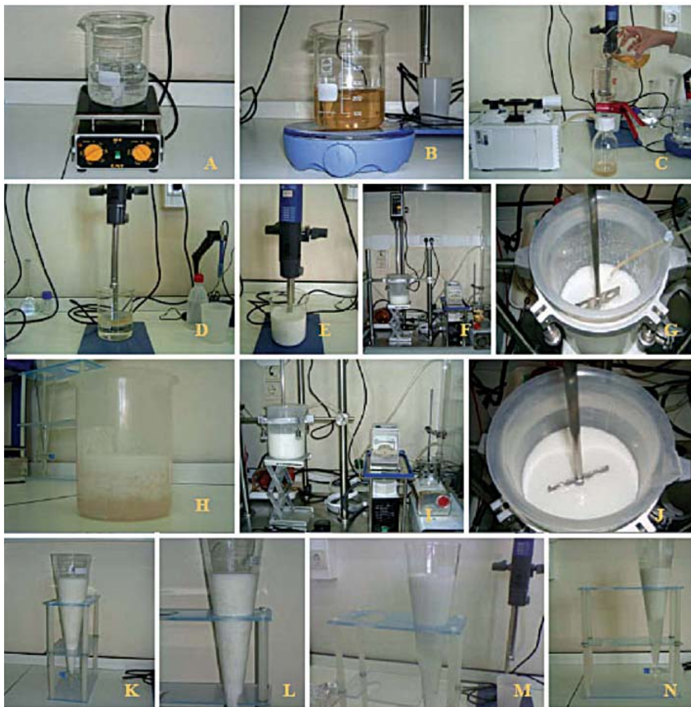
Figura 5. Fases del proceso de síntesis: Preparación de la emulsión (A-E), Precipitación del quitosano (F-H), Reticulación (I-J) e Separación/Lavado (K-N)
