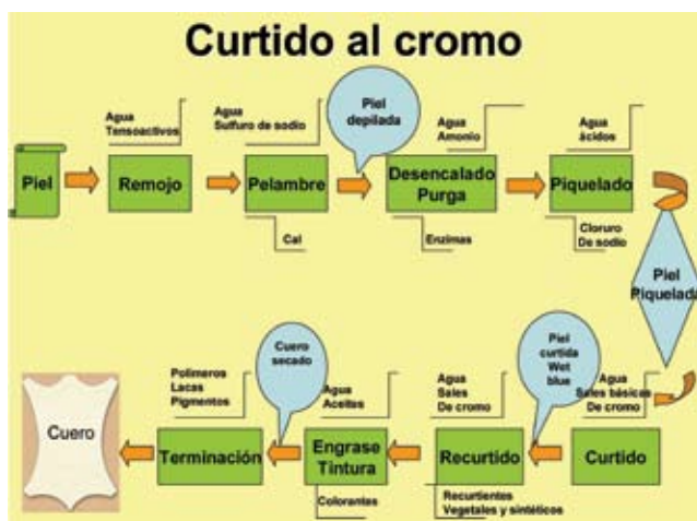
Figura 1 – Diagrama de flujo del proceso de curtido
