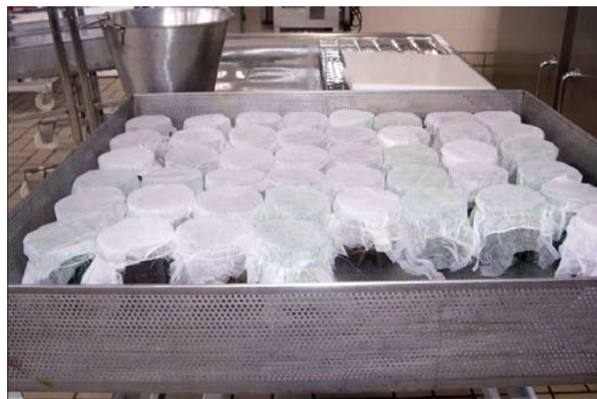
Figura 1. Bandeja conteniendo los recipientes de la primera etapa experimental listos para ser introducidos en la cámara de temperatura y humedad controladas.
