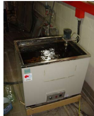
Figura 3. Baño termostatzado con control de temperatura.
