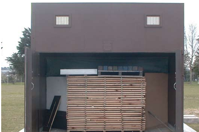
Figura 5. Secador solar de LATU con carga de E. grandis .
