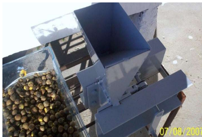
Figura 4. Rompedor mecánico del endocarpo leñoso.
