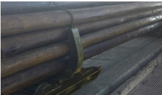
**Figura 13.** Salida de postes impregnados de autoclave.
