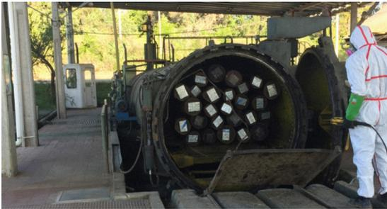
**Figura 11.** Postes dentro del autoclave.
