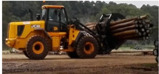
**Figura 14.** Cargador frontal transportando postes.
