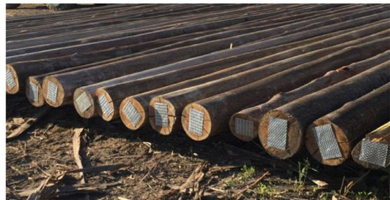
**Figura 10.** Camas para control e identificación de postes previo a la impregnación.
